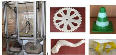
Şekil 1. Endüstriyel boyutlu çift başlı 3B yazıcı ve endüstriyel ürünler [16]
